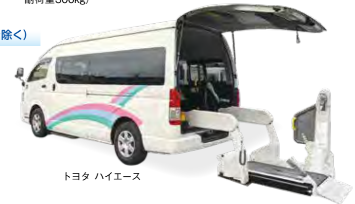
UDレベル1 (車椅子スロープ 耐荷重300kg)
